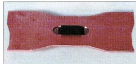
Bild 8. Neuester Typ mit geschlitztem Stromleiter (einfache Kupferschiene, hier für 200 A), in den das Sensormodul eingeklippt wird.
